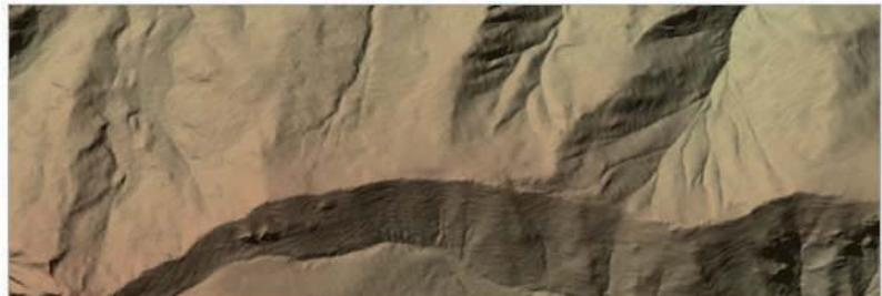
Il modello digitale del terreno, con passo di campionamento di 20 metri, utilizzato per le operazioni di ortorettifica è stato direttamente predisposto dalla Provincia di Torino utilizzando dati cartografici di diversa provenienza ma comunque derivati da cartografie a grande scala prodotte dalla provincia medesima.
