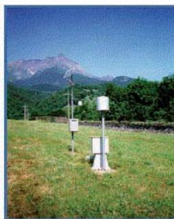
Una maglia più fitta di stazioni **Termopluviometriche** controlla la situazione di ogni bacino montano o collinare
