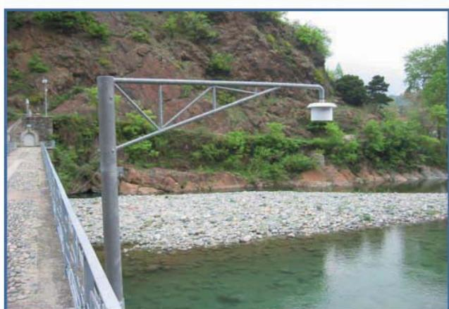
Idrometri ad ultrasuoni: acquisizione del dato ogni 30 min.
